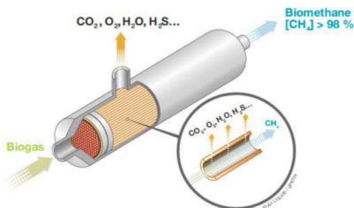
Figura 8 - Processo de separação por membrana.
