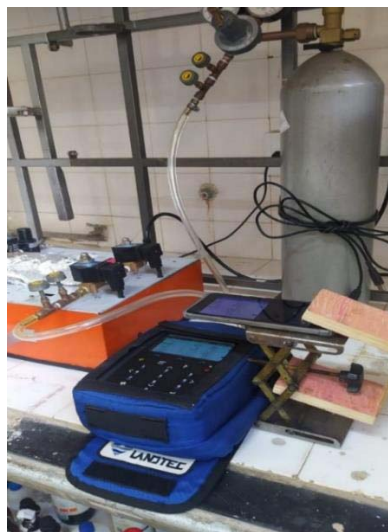
Figura 31 - Medição de frações molares gasosas a jusante do protótipo.
