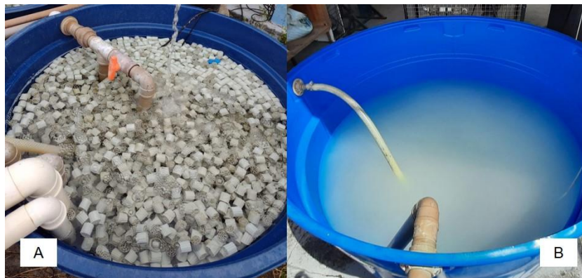
Figura 11 – Unidades utilizadas no sistema aquapônico. A: reator com mídias biológicas utilizado em ambos sistemas (AC e BUF) e B: caixa receptora com água supersaturada de oxigênio (BUF).
