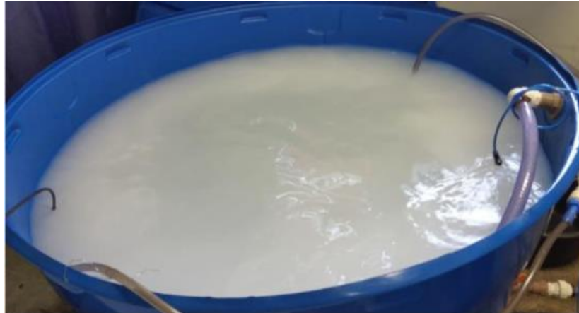
Figura 6 – Solução aquosa de aspecto leitoso provocado pela presença de microbolhas originadas no processo de produção de nanobolhas por cavitação hidráulica.
