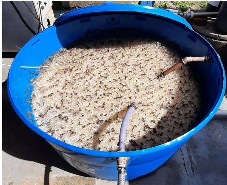
Figura 24 – Flotação de sólidos dissolvidos e particulados observada no sistema com a utilização de bolhas ultrafinas de oxigênio.
