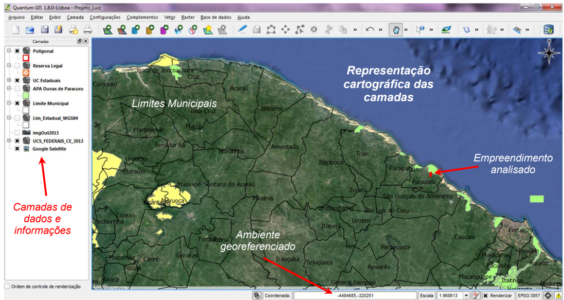
Figura 54 – Tela de visualização de um conjunto de camadas com imagem de satélite.
