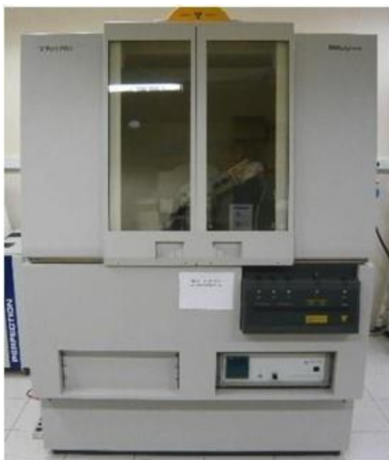
Figura 10 – Difratômetro PANalytical X'Pert PRO MPD, disponível no LRX.
