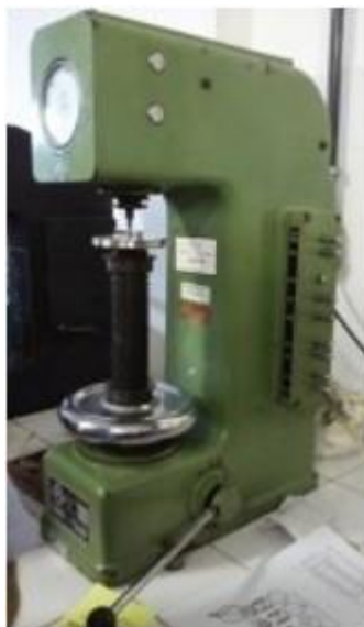
Figura 12 – Durômetro Rockwell(HR), disponível no LEM.
