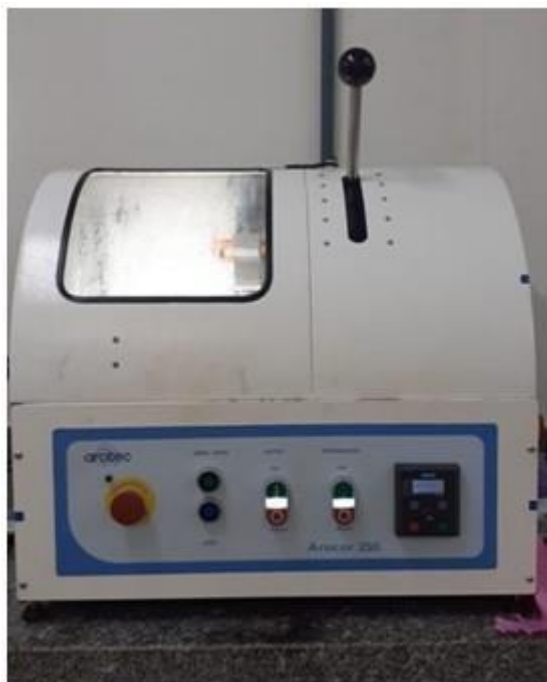
Figura 9 – Cut-off modelo AROCOR-250, disponível no LPC.
