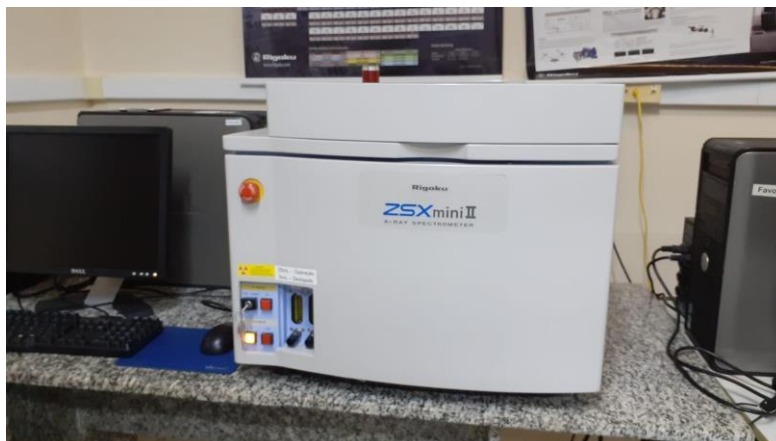
Figura 11 – Equipamento de FRX ZSXMini II, disponível no LRX.
