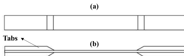
Figura 13 — Corpo de prova de compósito polimérico para ensaio de tração conforme norma ASTM D3039: (a) vista superior e (b) vista lateral
