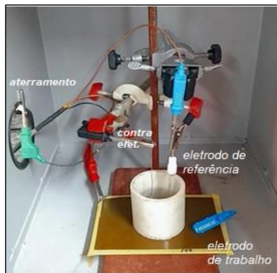
Figura 9 – Célula para análise por espectroscopia de impedância eletroquímica.
