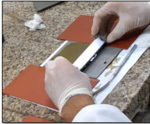
Figura 4 – Aplicação do revestimento no substrato metálico.
