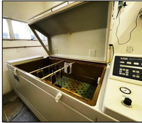
Figura 8 – Amostras posicionadas para o ensaio de névoa salina.
