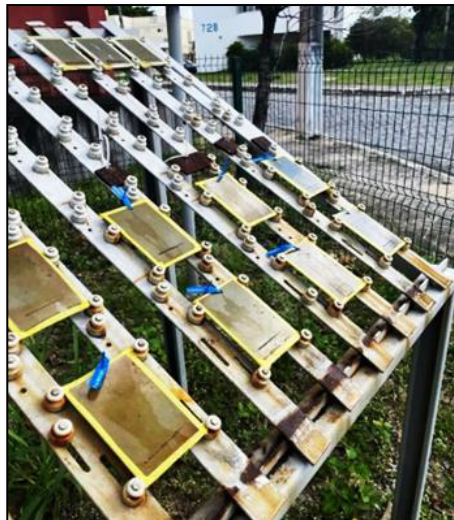
Figura 7 – Amostras posicionadas para o ensaio de exposição atmosférica na ECA/UFC.
