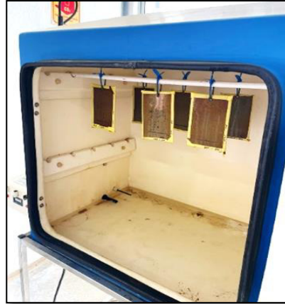
Figura 6 – Amostras durante ensaio de umidade saturada.
