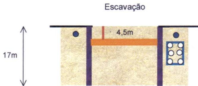
Parte da escavação é parcializada, principalmente onde a área encontra-se intensamente urbanizada, sendo executada em cada 2 lamelas por módulo, ou seja, a cada 4,40m. Em outras áreas onde não existe construções próximas as instalação das paredes diafragmas é feita uma escavação por módulo, chegando-se a profundidade requerida pelo projeto de 4,5m, para a execução da laje superior do túnel do Trem Metropolitano de Fortaleza.
