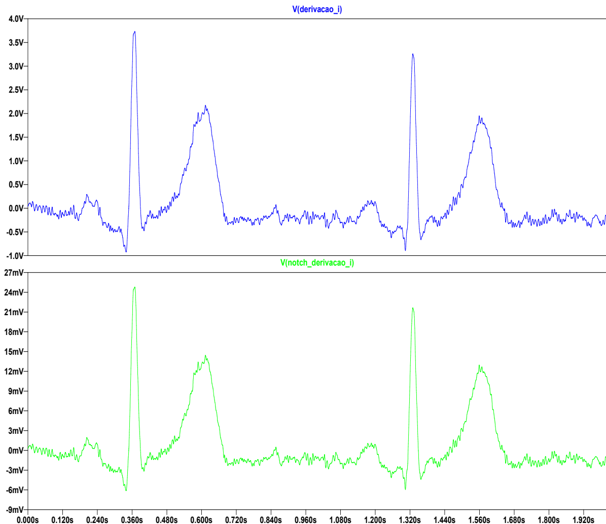
Figura 36 – Simulação: Etapa de Amplificação da Derivação I
