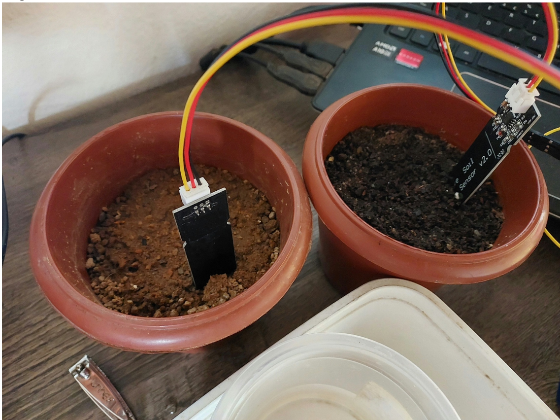
Figura 17 – Sensores em teste de umidade do solo.
