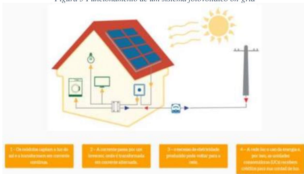
Figura 5 Funcionamento de um sistema fotovoltaico on-grid
