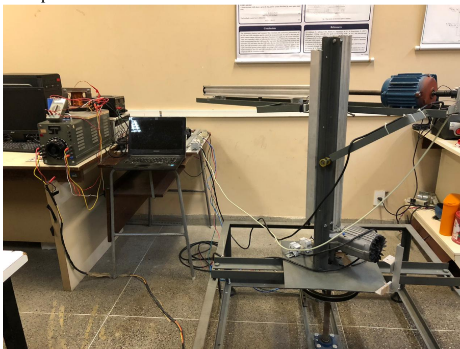
Figura 62 – Manipulador cilíndrico utilizado na tese.
