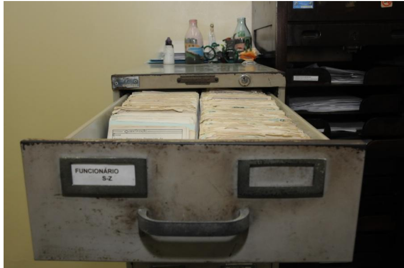
FOTO 1 – Aspecto corrosivo de estantes metálicas que acondicionam fichas e prontuários do paciente FONTE: Marcela Teixeira. Arquivista UFC. Fotógrafo: Arlindo Barreto – Memorial UFC
