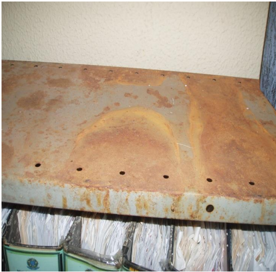
FOTOS 5 e 6 – Corrosão de estante e prendedor metálicos FONTE: Dados da pesquisa. Ago. 2012
