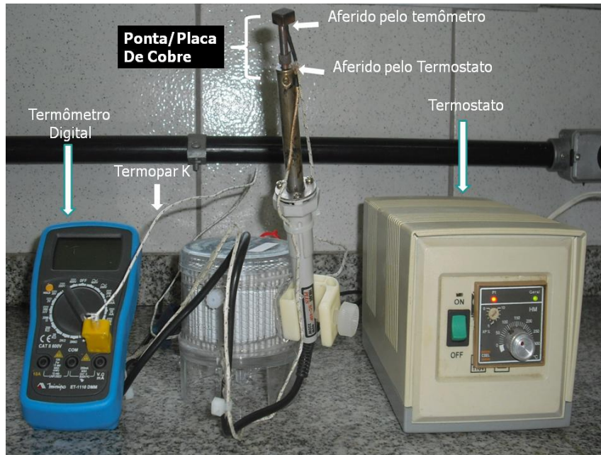
Figura 8. Equipamento completo utilizado para realização da queimadura. Observar termômetro digital, termopar tipo K na ponta, estabilizador de corrente elétrica com termostato interno.
