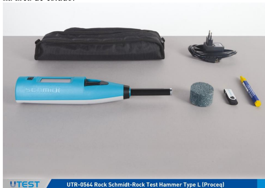
Figura 12 – Esclerômetro para rocha (Schimdt Hammer) tipo L, utilizado para os ensaios geomecânicos na área de estudo.
