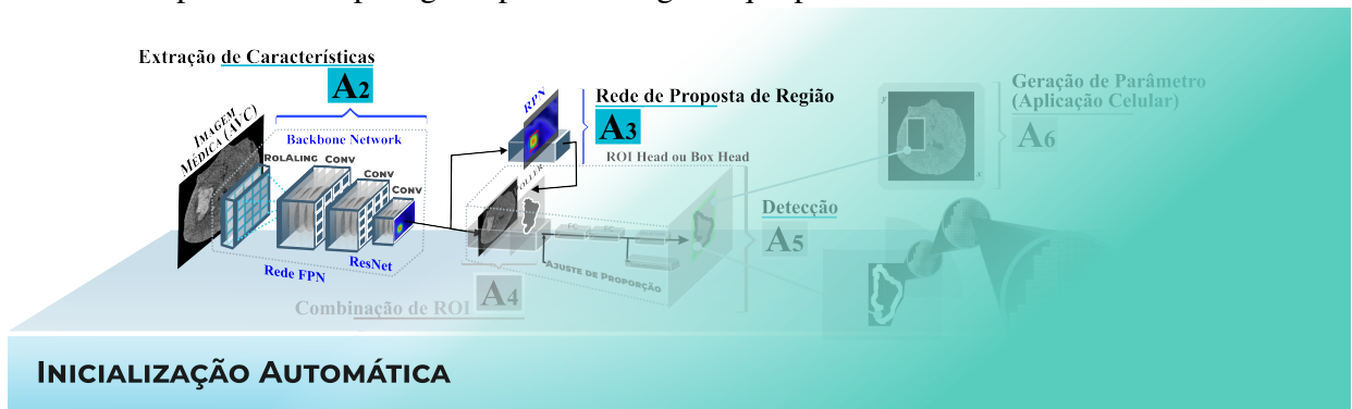
Figura 14 – Aplicação do processo de RPN no mapa de características extraídas e geradas no processo A2 para gerar possíveis regiões que podem ou não ser as áreas de interesse.
