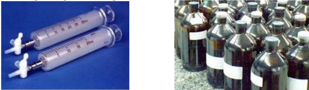
Figura 5 – Recipientes para amostragem de óleo isolante (a) seringa e (b) frasco
