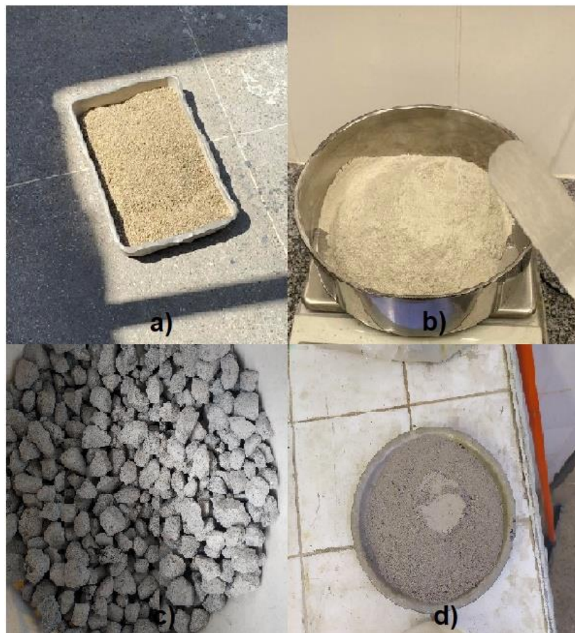
Figura 4 – a) GGBS natural; b) GGBS após o peneiramento; c) BOF natural; d) BOF após o peneiramento
