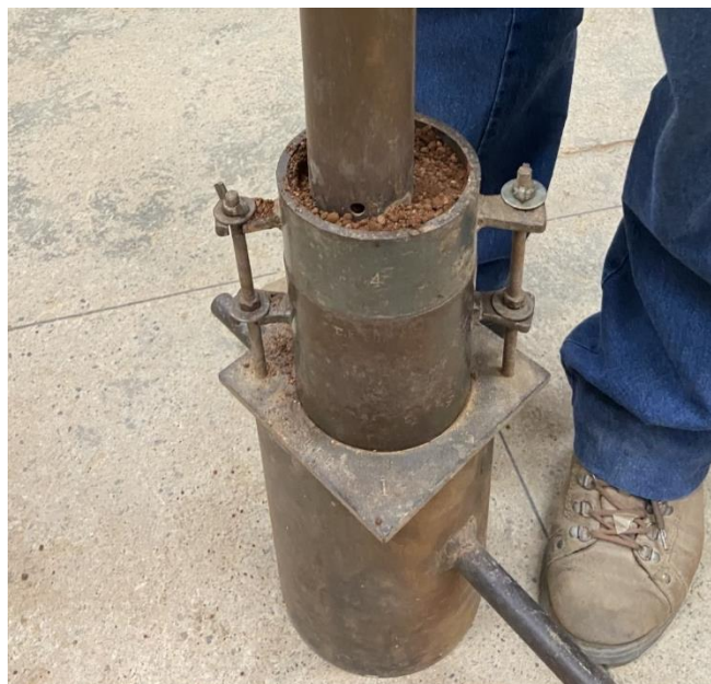
Figura 9 - Compactação do Solo A no cilindro pequeno.
