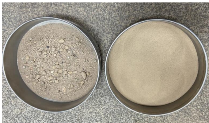
Figura 4 - Amostra de Solo B retido e passante na peneira Nº 40.
