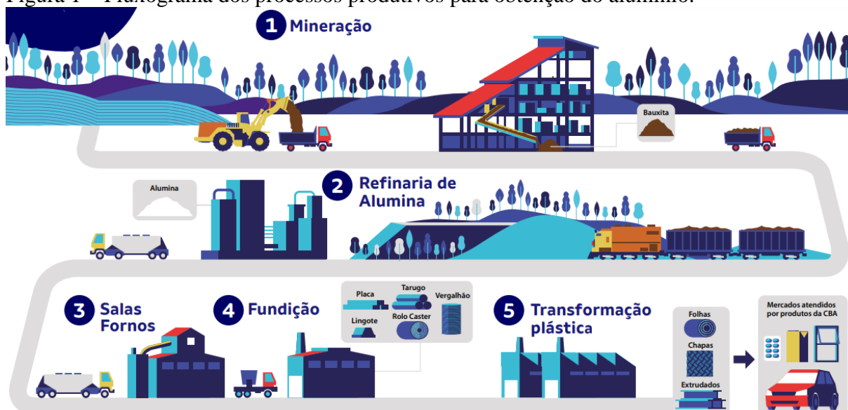
Figura 1 – Fluxograma dos processos produtivos para obtenção do alumínio.
