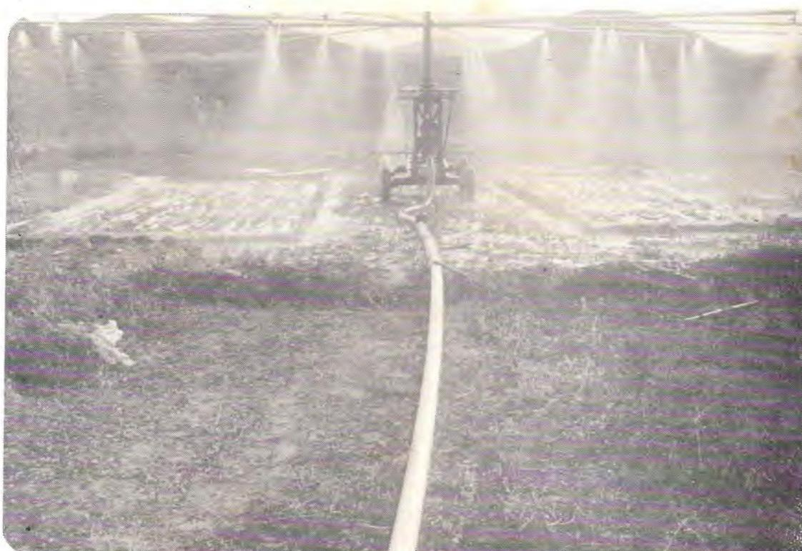
Figura 6. Aplicação da chuva simulada do tratamento T<sub>2</sub> no Podzólico Vermelho Amarelo Equivalente Eutrófico.
