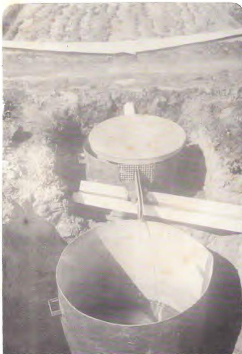
**Figura 7.** Detalhe da coleta do deflúvio, observando-se o funcionamento dos tanques coletores, divisor de furos e calha utilizada para conduzir 14/15 da enxurrada para fora das trincheiras onde estão colocados os tanques.
