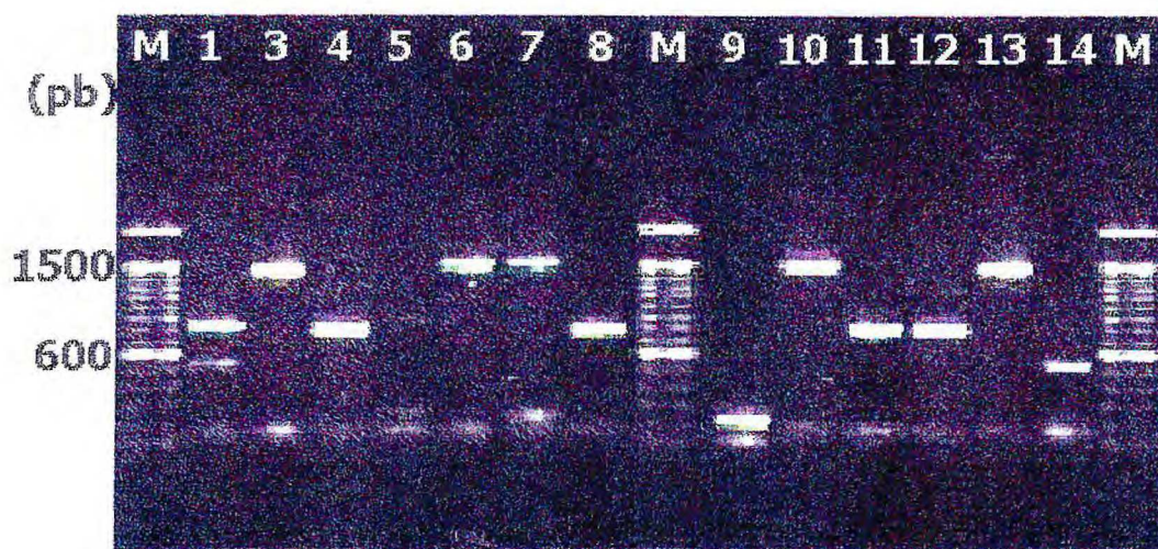
FIGURA 26 – Tamanho dos insertos positivos para AOX dos diferentes clones \lambda ZIPLOX isolados no 3º "screening". Eletroforese em gel de agarose 0,8% dos insertos amplificados por PCR usando os primers universais M13. Os números de 1 a 14 indicam os respectivos clones e M o marcador de tamanho molecular (DNA "ladder" 100bp).
