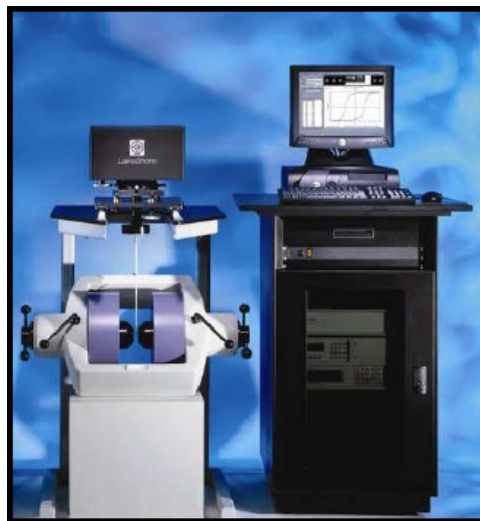
Figura 3.2: Magnetômetro de amostra vibrante do Instituto de Física e Química da UNIFEI usado para a realização das medidas magnéticas.
