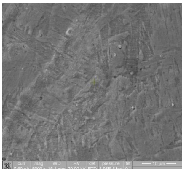
Figura 69 – Microestrutura do 5º cordão da amostra MCR1 obtida por (MEV).
