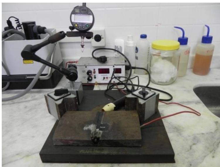
Figura 40 – Sistema utilizado no polimento eletrolítico.
