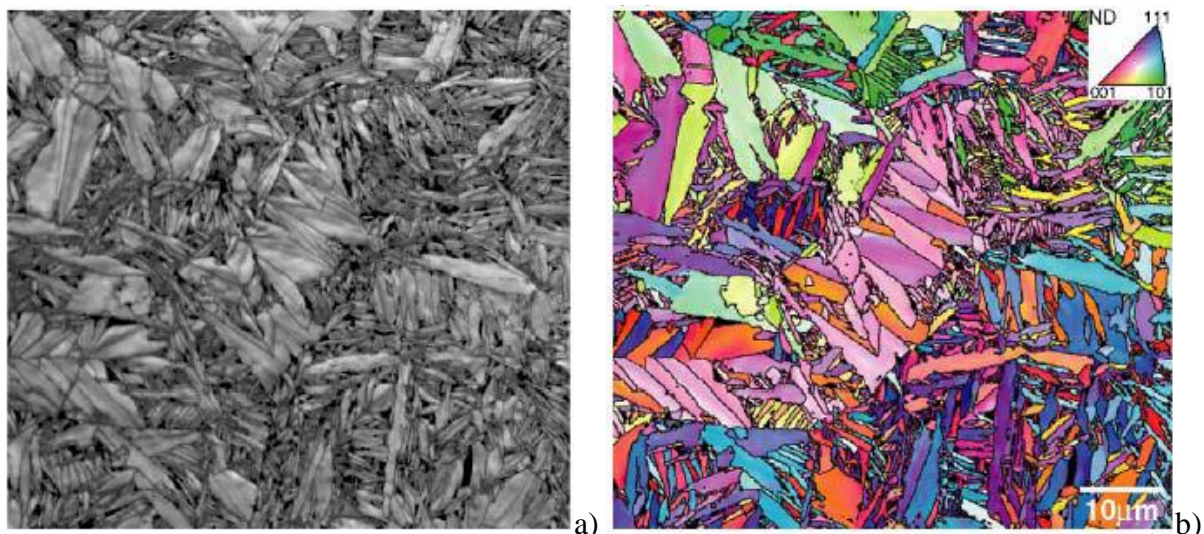
Figura 22 – Mapeamento das orientações da martensita na liga Fe-28,5%Ni: (a) mapa de IQ (b) mapa de orientação de grãos. Em (b) as cores representam as orientações perpendiculares ao plano de observação, indicado no triângulo estereográfico.
