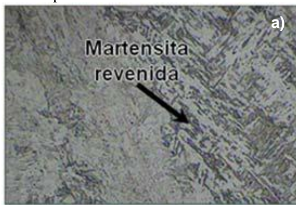
Figura 27 – Microestruturas do metal de solda para as amostras 1 e 2 após tratamento térmico para alívio de tensões residuais.
