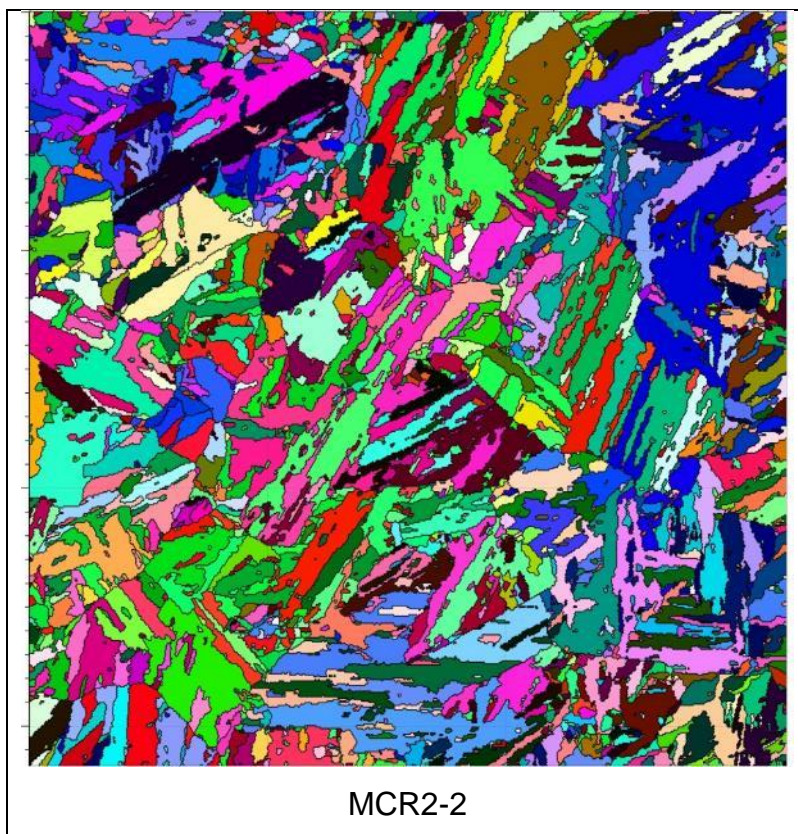
Figura 81 – Mapa de orientação por cor da junta MCR2, sendo a), b), c) e d) amostras da 2°, 3°, 4° e 5° cordões, respectivamente.
