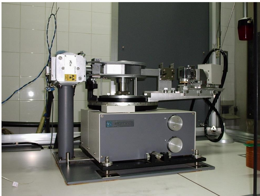
Figura 13 - Difratômetro para amostras policristalinas modelo DMAXB – Rigaku gerador de raios-X de 2kW
