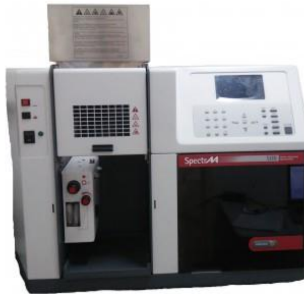
Figura 10 - Espectrofotômetro VARIAN SpectrAA 50B utilizado na determinação dos metais contaminantes
