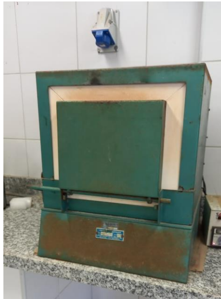
Figura 2 - Forno tipo mufla, utilizado na produção dos biocarvões de bagaço de cana-de-açúcar
