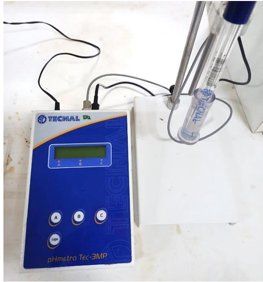
Figura 5 - Equipamento de medição de pH
