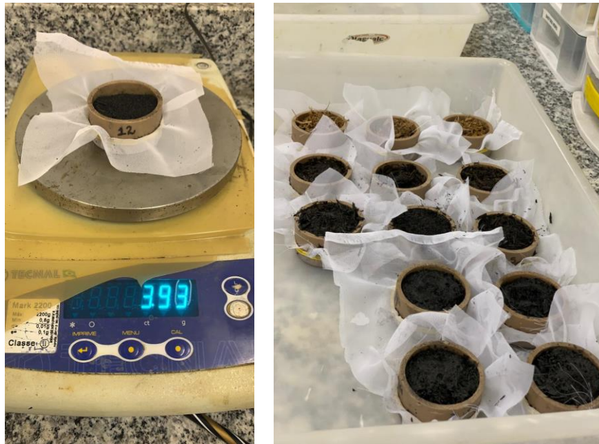
Figura 9 - Pesagem e saturação das amostras de bagaço de cana-de-açúcar e dos biocarvões produzidos em diferentes temperaturas, para determinação da Capacidade de Retenção de Água (CRA) conforme o método oficial para condicionador de solos (BRASIL, 2007a, 2008)
