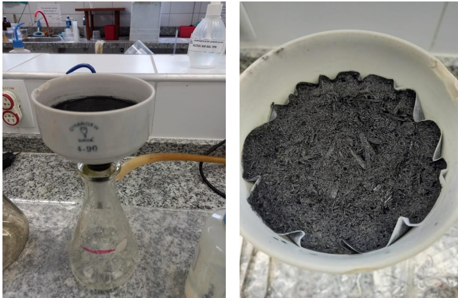
Figura 8 - Sistema de filtração à vácuo empregado na determinação da Capacidade de Troca de Cátions (CTC) conforme o método oficial para condicionador de solos (BRASIL, 2007a)
