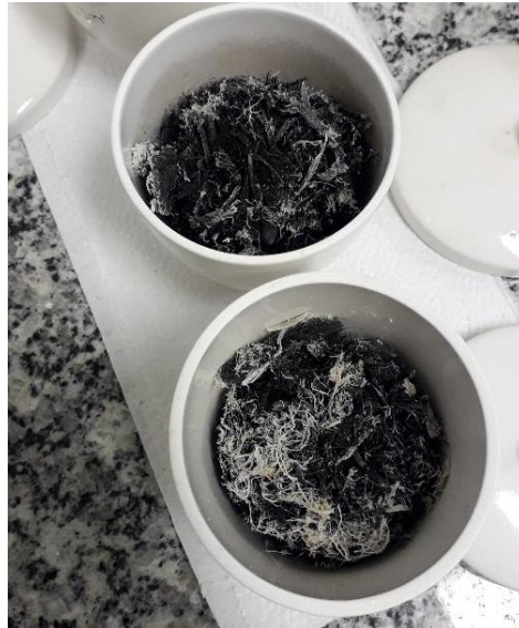
Figura 4 - Biocarvão de bagaço de cana-de-açúcar com presença de cinzas na superfície
