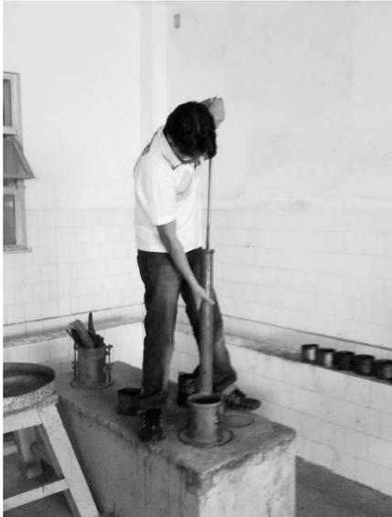
**Figura 01** - Ensaio de compactação.
