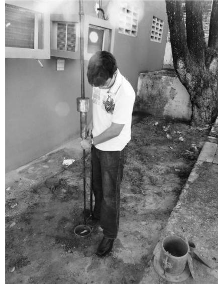
**Figura 03** - Ensaio de DCP.
