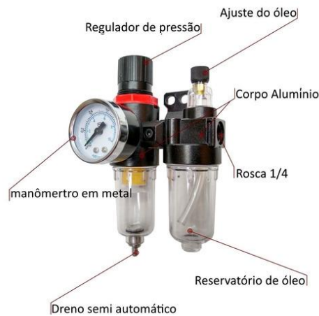
Figura 23 – Unidade de conservação pneumática - Lubrifil
