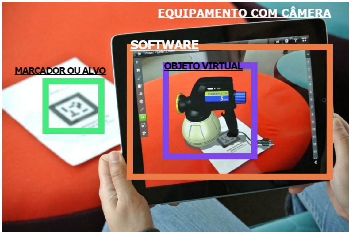
Figura 2 – Exemplificação de como funciona a realidade aumentada e como os elementos se relacionam
