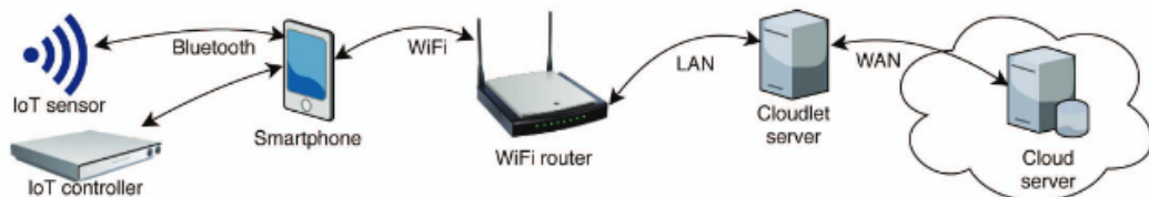
Figura 4 – Solução de edge computing usando IoT e dispositivos de borda.
