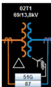
Figura 3.11: Principais funções de proteção associadas aos transformadores.
