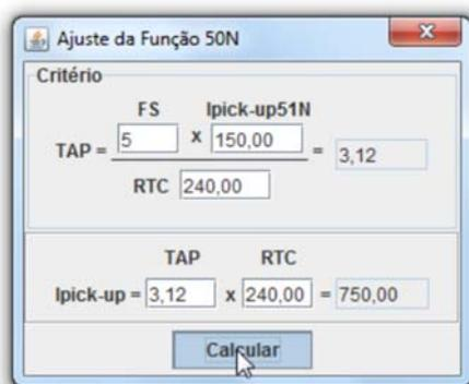
Figura 3.31: Ajuste da Função 50N.
