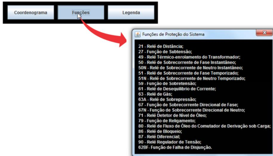
Figura 3.13: Código das principais funções de proteção utilizadas no software.
