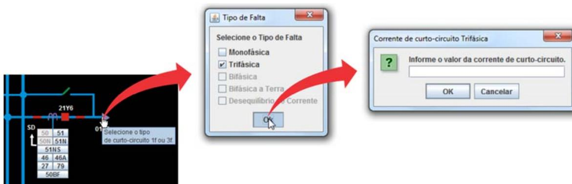
Figura 3.16: Seleção do tipo e valor da corrente de curto-circuito (Alimentador 01Y6).
