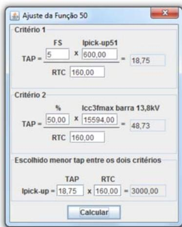
Figura 3.21: Configuração do ajuste da função 50 do relé do alimentador 01Y6.
