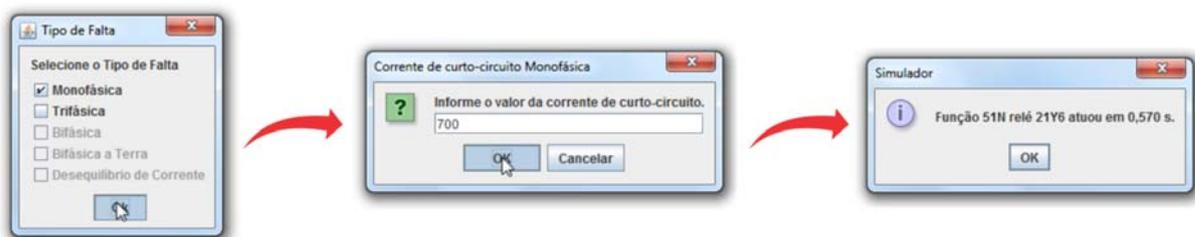
Figura 3.36: Simulação de falta monofásica: tempo de atuação função 51N.
