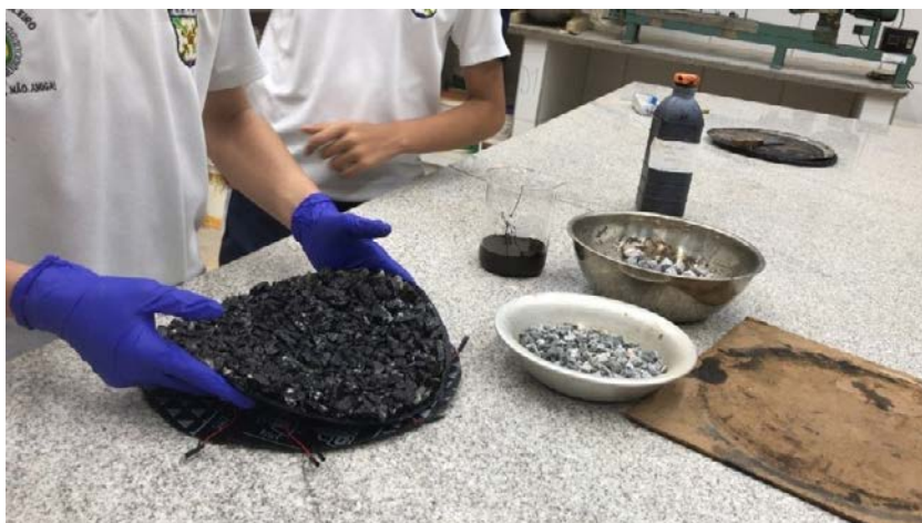
Figura 5 - Colocação do corpo de prova de TSD sob as células e as leds
