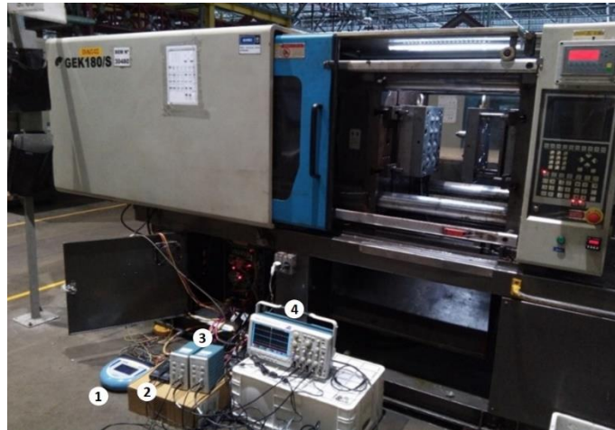
Figura 34: Montagem dos equipamentos de medição na Injetora
