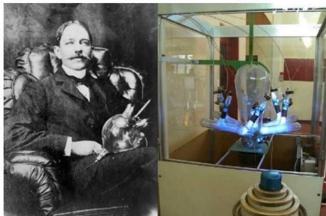
Figura 5. A esquerda Peter Cooper Hewitt segurando sua invenção e à direita uma válvula retificadora em funcionamento numa estação de rádio AM em Beromünster na Suíça
