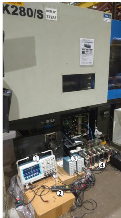
Figura 47: Banco de capacitores e instrumentos de medidas conectados a injetora. 1. Osciloscópio, 2. Ponteira de alta tensão, 3. Amplificador das ponteiras de corrente e 4. Banco de capacitores.
