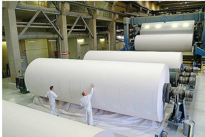
Figura 46: Produção de rolos de papel com 10 m de largura e até 200 m de comprimento para indústria gráfica.
