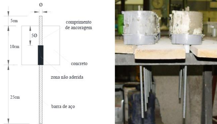
Figura 2.16 – Esquema detalhado e foto dos CPs pull-out recém moldados
