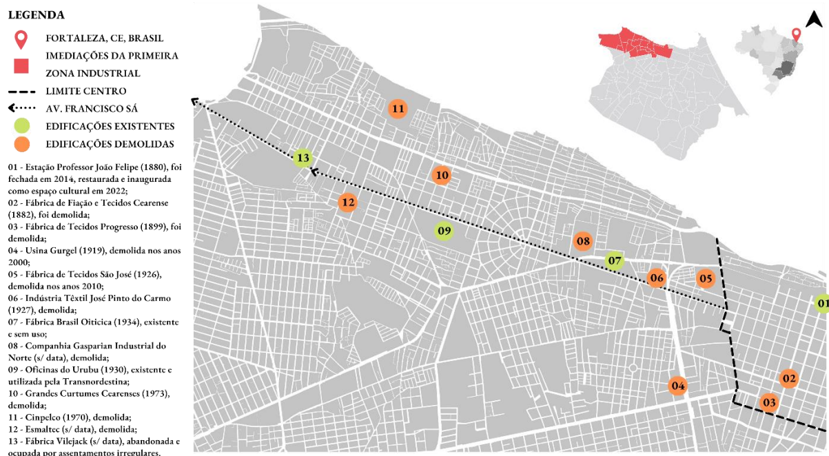
Figura 1.18 – Levantamento de indústrias/fábricas na primeira zona industrial de Fortaleza com a relação das remanescentes e das demolidas. Fonte: Elaborado pela autora, 2021.
