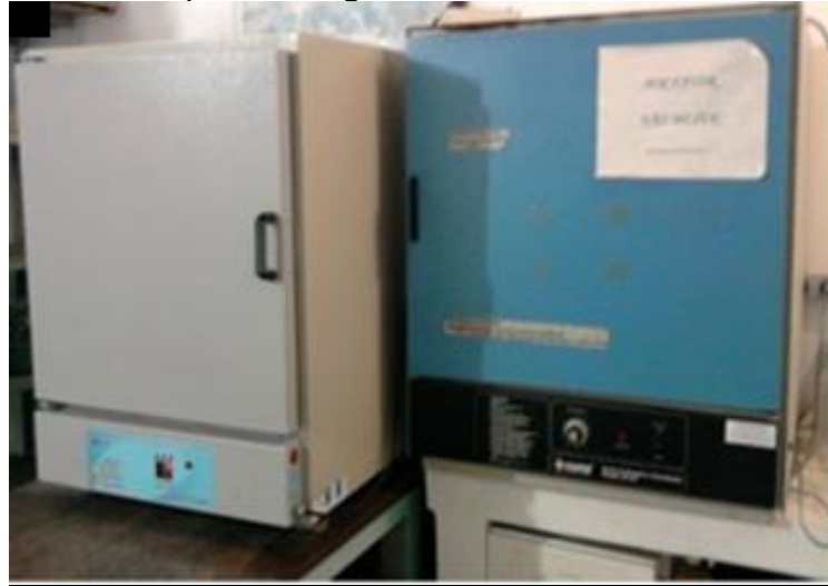
Figura 9 – Estufa para secagem das amostras do LGGM-CTG-UFPE
