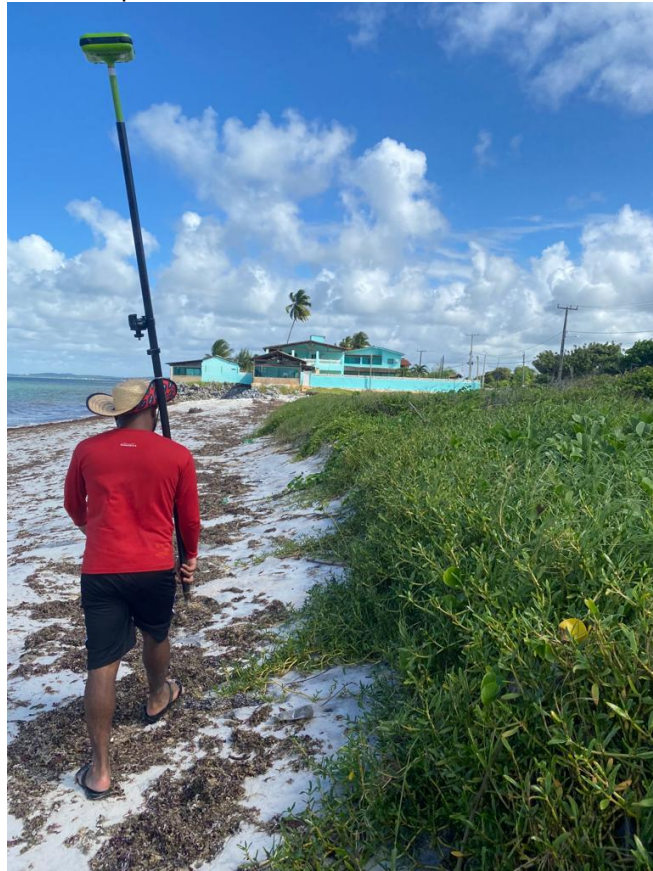
Figura 12 - Receptor utilizado no caminhamento para coleta de pontos no levantamento da linha de preamar máxima da área estudada.
