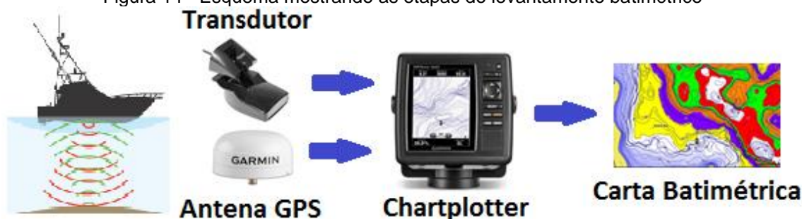
Figura 14 - Esquema mostrando as etapas do levantamento batimétrico
