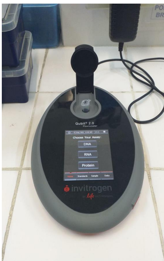
Figura 15 – Etapa de leitura dos tubos em Fluorímetro Qubit 2.0® para quantificação do cfDNA
