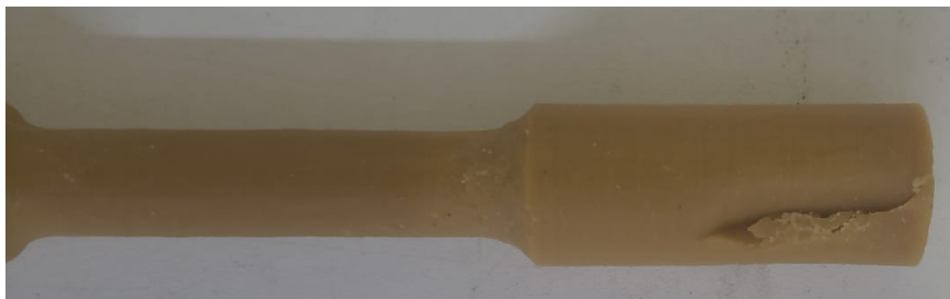
Figura 21 - Corpo de prova em cera com defeitos
