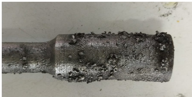
Figura 17 - Corpo de prova com Gota Fria
