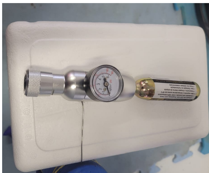
Figura 09 - Recipiente fechado e injeção de CO 2
