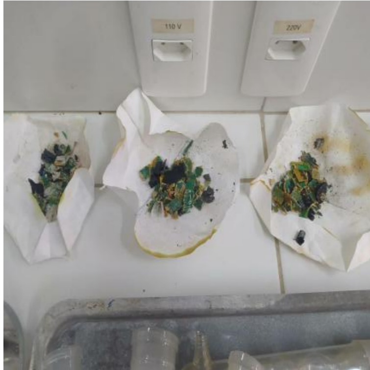
Figura 9 – Material retido no filtro apos lavagem e secagem.
