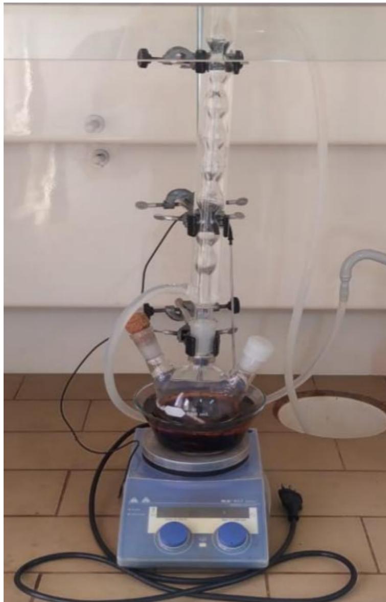
Figura 12 – Montagem das vidrarias para o ensaio de lixiviação.
