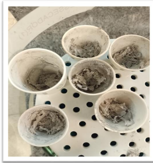
Figura 13. Amostra incinerada para análise do teor de cinzas. FONTE: AUTOR (2022).
