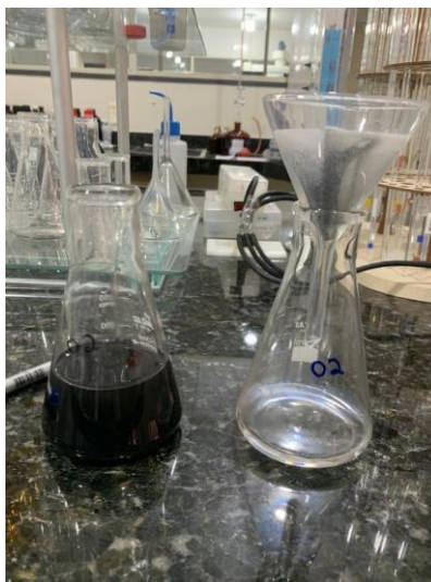
Figura 8 - Filtração do carvão ativado após processo de adsorção
