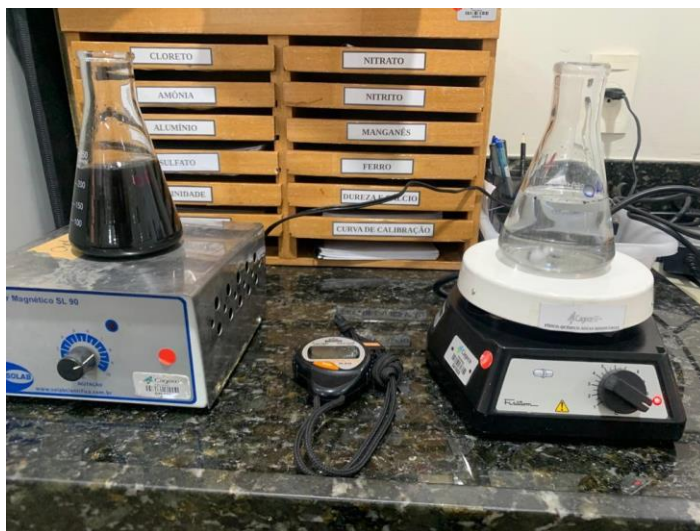
Figura 7 - Execução dos testes de adsorção variando tempo de contato e concentração
