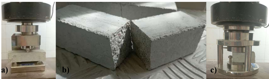
Figura 12 - a) Rompimento para resistência à tração na flexão; b) corpo de prova rompido; c) Rompimento para resistência à compressão axial.
