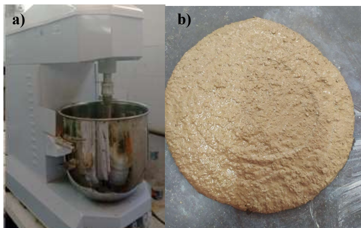
Figura 9 - a) Argamassadeira; b) Espalhamento da argamassa teste.
