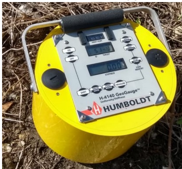
Figura 5 - Detalhes do equipamento Humboldt GeoGauge™ sobre o solo de cobertura do ASMOC
