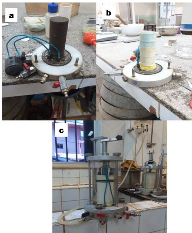
Figura 16- Montagem da célula triaxial: a) colocação do CP sob pedra porosa; b) envolvimento do CP com as membranas látex, c) preenchimento da célula triaxial com água
