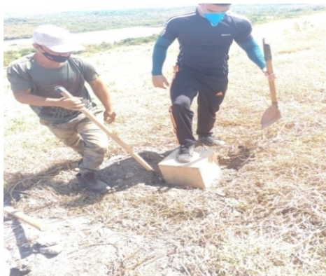
Figura 10 - Retirada da amostra indeformada na camada de cobertura final do ASMOC
