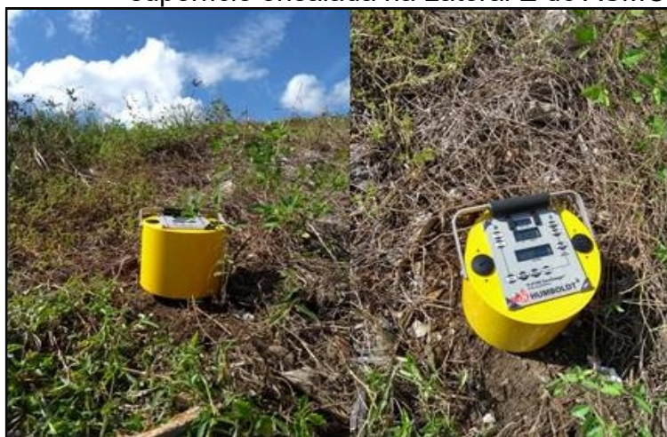
Figura 7 - Imagem da lateral E de cima do Humbolt GeoGauge™ sobre a superfície ensaiada na Lateral E do ASMOC
