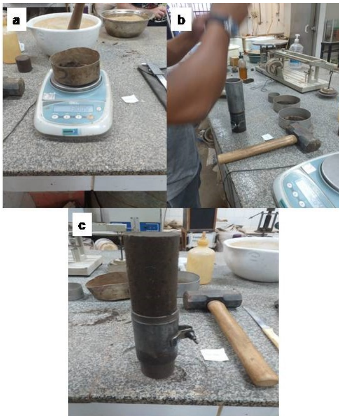
Figura 15 - Moldagem do CP para os ensaios triaxiais: a) pesagem das camadas de solo, b) preenchimento da cápsula de moldagem, c) desmoldagem do CP
