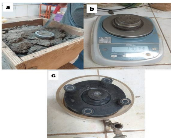
Figura 11- Ensaio de adensamento: a) moldagem e retirada do corpo de prova, b) pesagem do conjunto anel e solo, c) confinamento do corpo de prova
