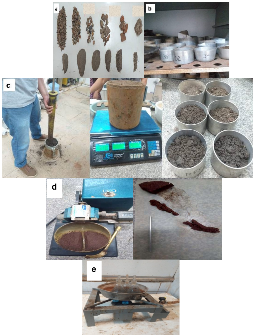
Figura 9 - Caracterização física do solo em laboratório: a) granulometria por peneiramento, b) umidades natural e higroscópica, c) limites de Artteberg, d) compactação, e) densidade real dos grãos
