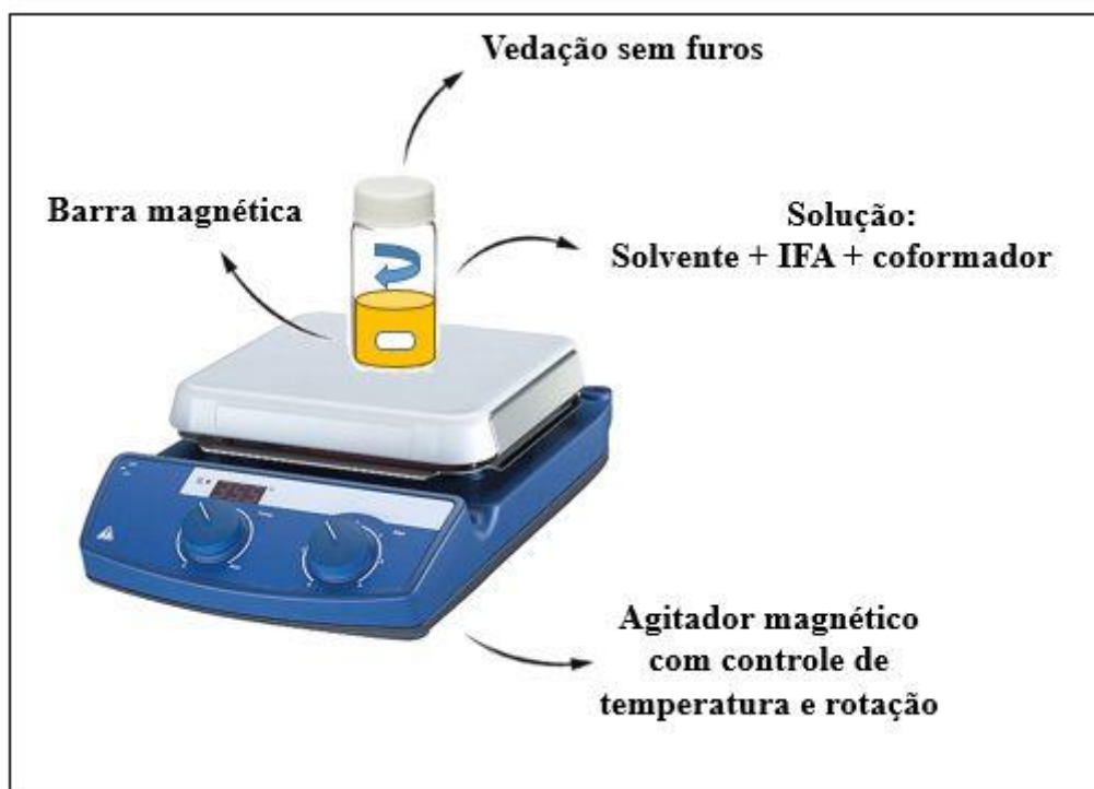
Figura 5. Representação esquemática da técnica de cristalização por slurry .
