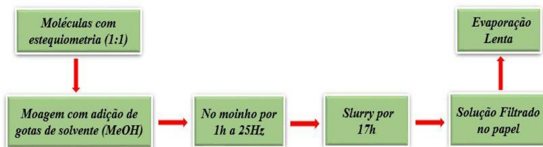
Figura 11. Esquema do processo de obtenção de cristais para os sólidos ODT-3,5DTA2 e ODTCl-3,5DTA3.
