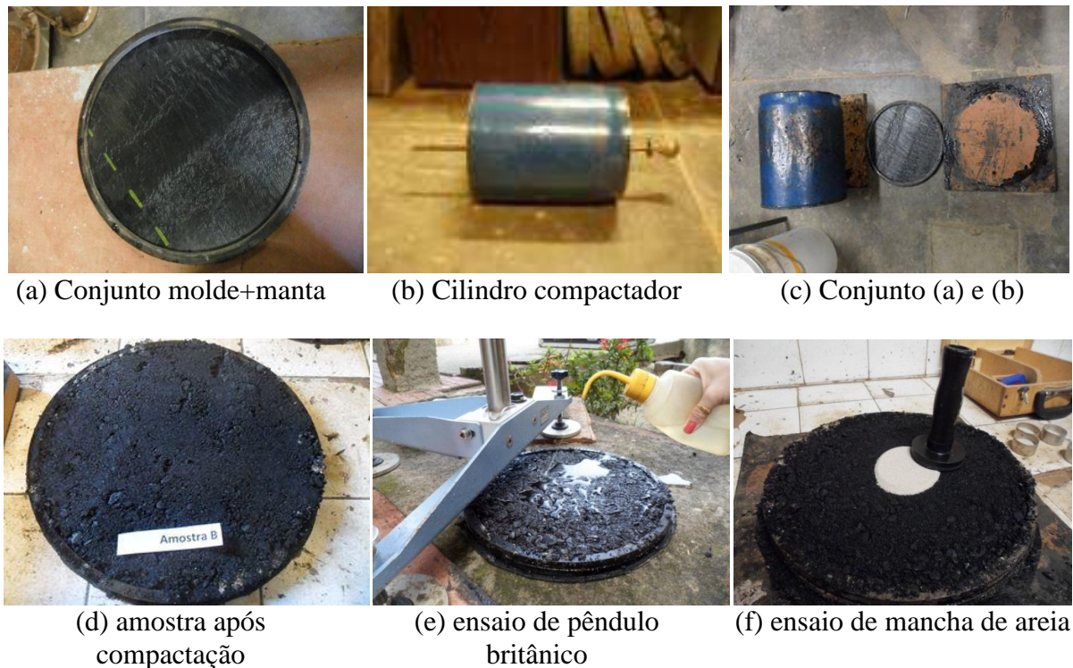
Figura 3: Procedimento para confecção de corpos de prova em laboratório proposto na presente pesquisa para a realização do ensaio de aderência
