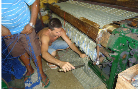
Figura 17 – Corte manual inadequado e inexistência de uso de EPIs (equipamentos de proteção individual)
