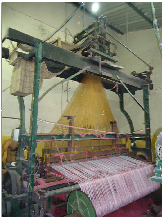
Figura 16 – Antiga máquina de tear utilizada na produção de redes da Requite
