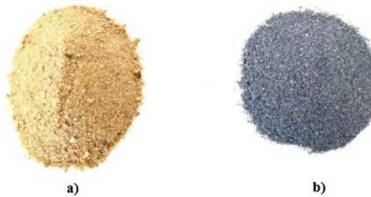
Figura 2: Identificação dos agregados miúdos a) areia natural e b) escória de aciaria BSSF
