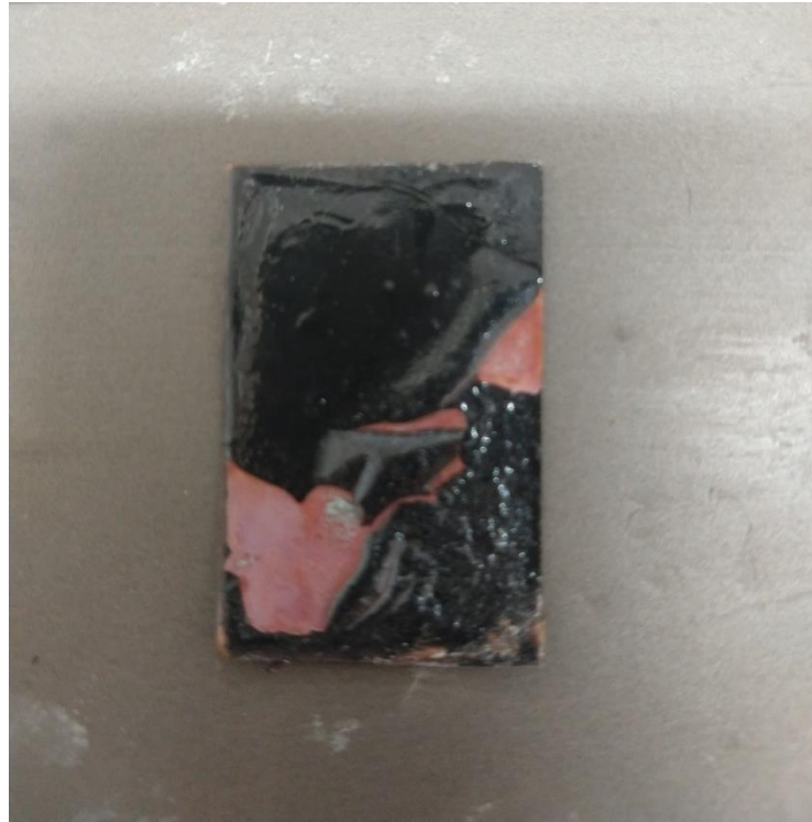
Figura 10 – Fragilização da superfície seletiva
