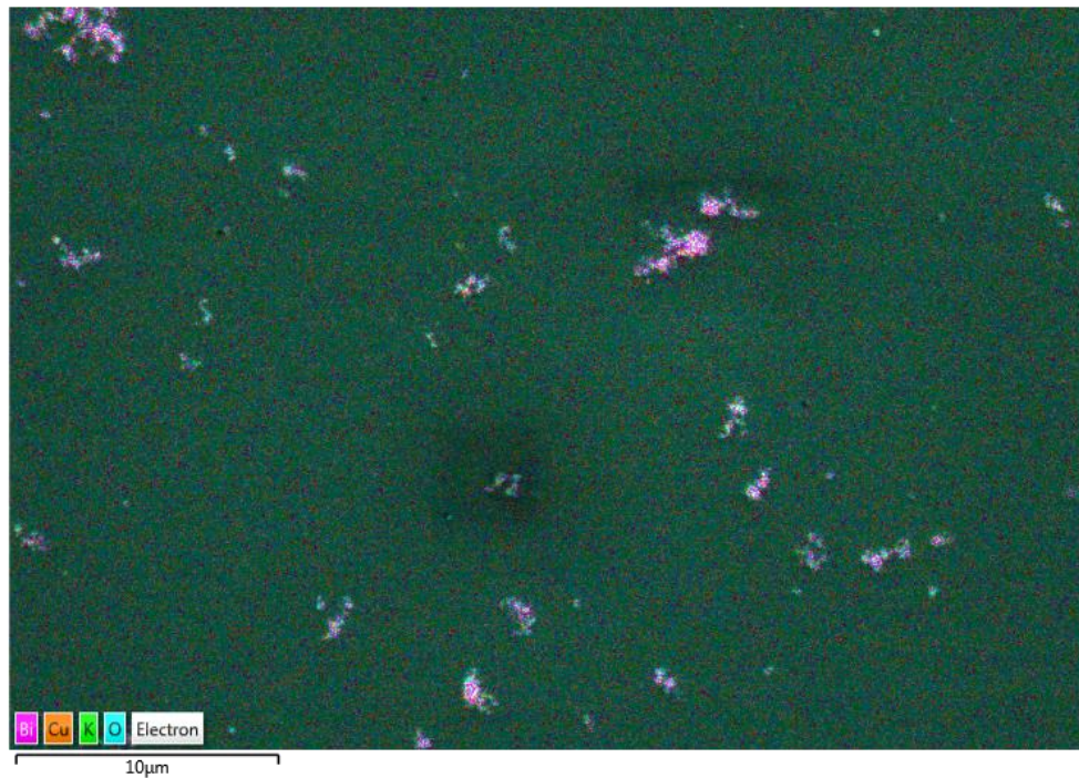
Figura 23 – EDS da superfície seletiva contendo LCC técnico
