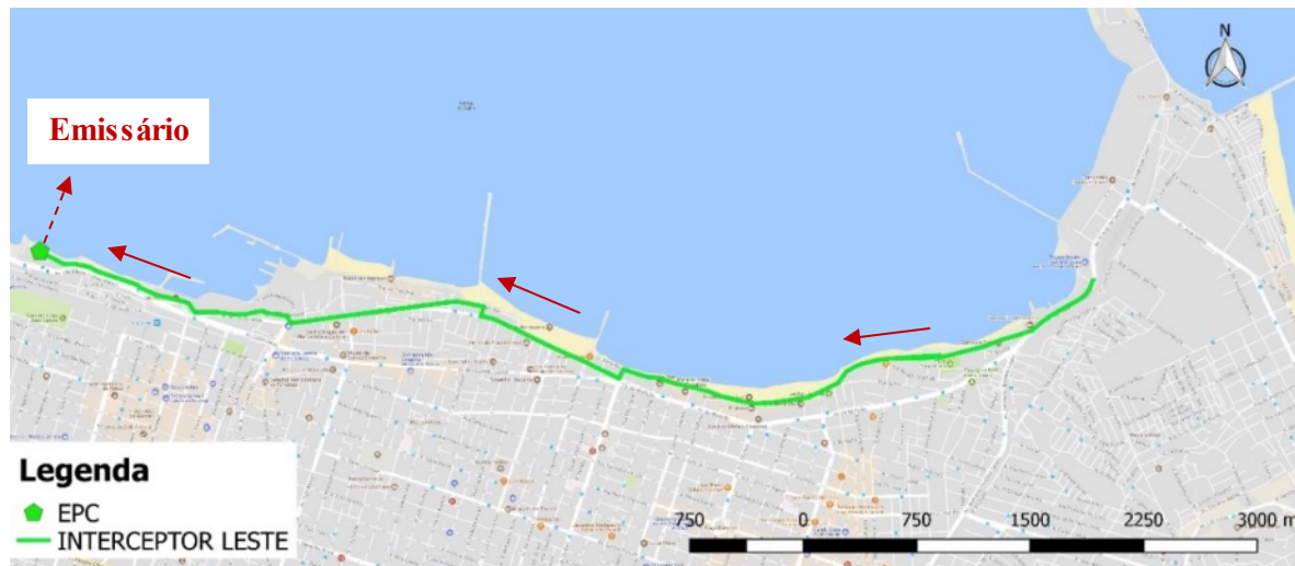
Figura 1 - Imagem do software QGIS com identificação do Interceptor Leste (IL) de Fortaleza-CE interligado à Estação de Pré-condicionamento de Esgoto (EPC), de onde o efluente é encaminhado para um emissário submarino.
