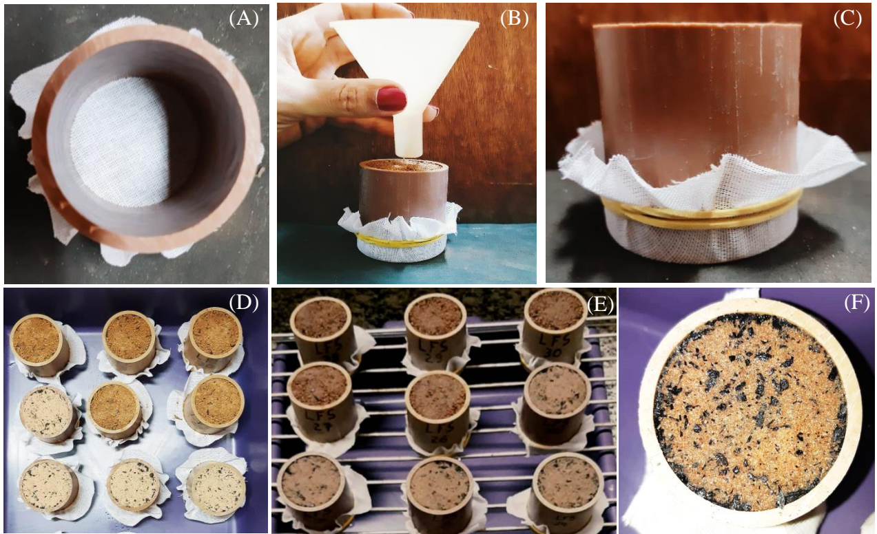
Figura 9 - Unidades experimentais preparadas e acondicionadas em cilindros de PVC.
