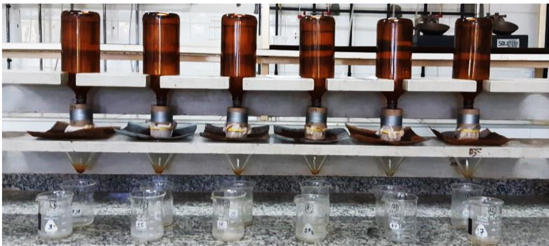
Figura 12 - Esquema para análise da condutividade hidráulica saturada em permeâmetro de carga constante.
