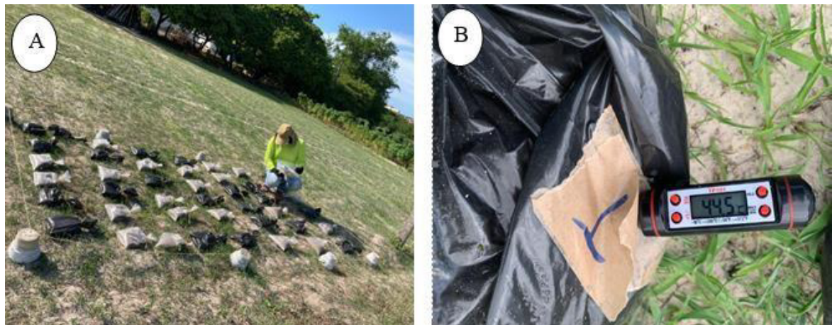
Figura 7. Aferição das temperaturas: A) Visão geral em uma das aferições; B) Detalhe do geotermômetro Soil Control durante a aferição da temperatura.
